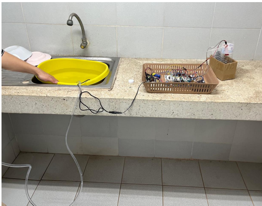
図 3. Arduino を用いた給水システムで給水を行う様子
